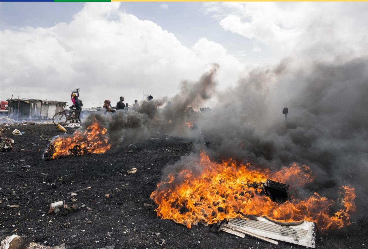
**Cavi e pneumatici bruciati per l'estrazione del rame**, che costituisce una parte delle attività del cantiere di rottami metallici.
