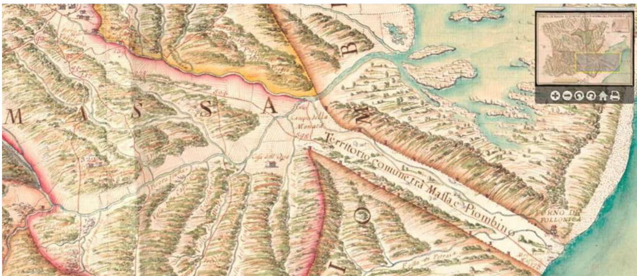
Figura 10 - Pianta di Massa attenente alla Magona del ferro di S.A.R, datazione 1765-70 e particolari lungo il corso del fiume Pecora e della Gora delle Ferriere. Nella località individuata come Campo della Monaca è possibile osservare la deviazione dei corsi d'acqua con una steccaia per alimentare i forni di Follonica.
