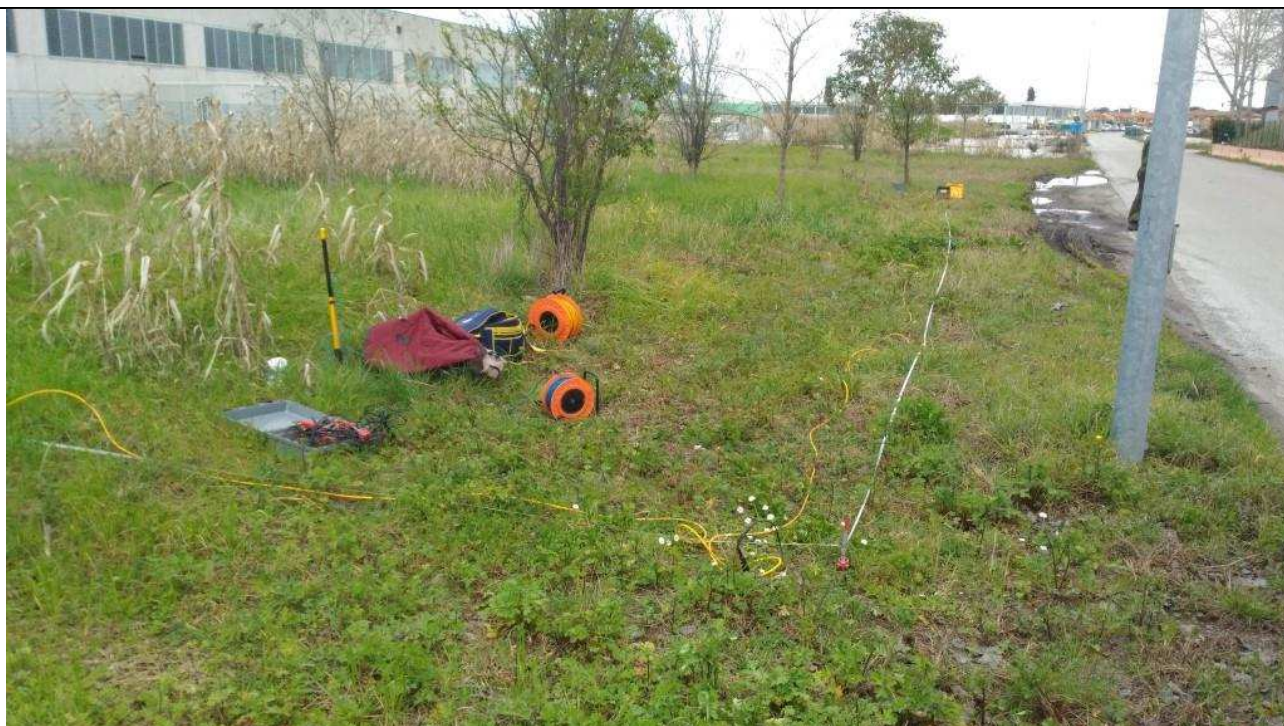
Foto 6 - indagine sismica ESAC 3
