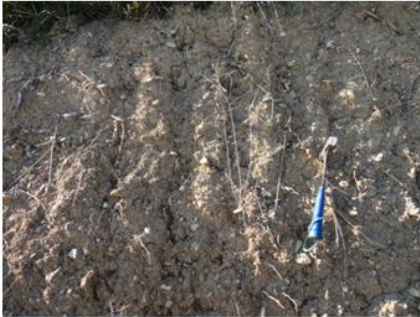
Figura 24. Caratteristiche dei depositi eluvio-colluviali costituiti da clasti immersi in matrice sabbioso-limosa
