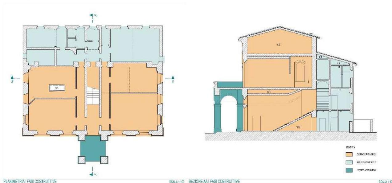
Fasi costruttive, planimetria e sezione. Progetto a cura di Ingegneria e Dintorni per il Comune di Vicopisano
